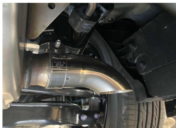
マフラー本体の水抜き穴側面より10mm外側の位置で切断する。
