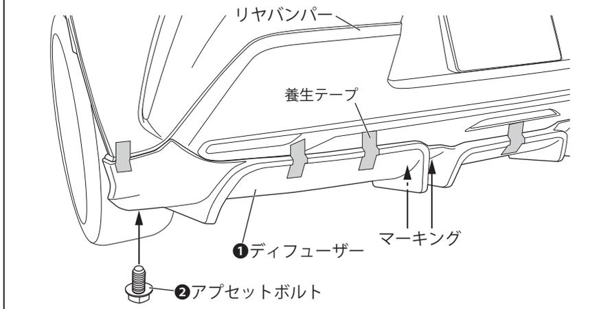
②**①**ディフューザーを車両に仮合わせし、下面を**②**アプセットボルトで仮締めし、各部位に隙間等問題が無いことを確認して養生テープ等で仮固定します。
