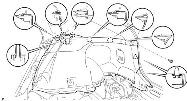
7. ツメ7箇所およびクリップ2箇所のかん合をはずし、デッキトリムサイドパネルASSY RHを作業が可能な範囲内まで外す。(LH側も同様。)
