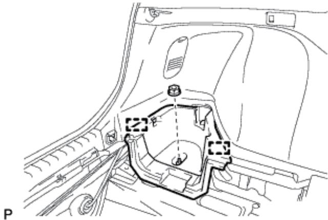
6. クリップを取りはずす。ガイド2箇所をはずし、デッキフロアボックスLHを取りはずす。
