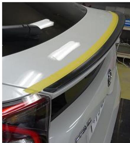
4. ①スポイラーの前後左右位置を合わせ、取り付け位置を確認後、両面テープ離形紙を引き抜きながら剥がし、圧着をする。
