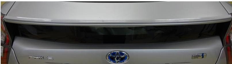
1.①スポイラーを車両にあてがい、左図を参考に取り付け位置を確認する。
