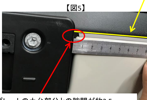
ライセンスプレートの土台部分との隙間が約3.5mm
