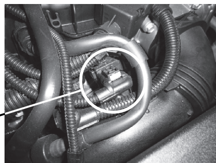
圧力センサー（サブ側）
